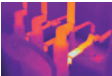
Termografická snímka vypínača
