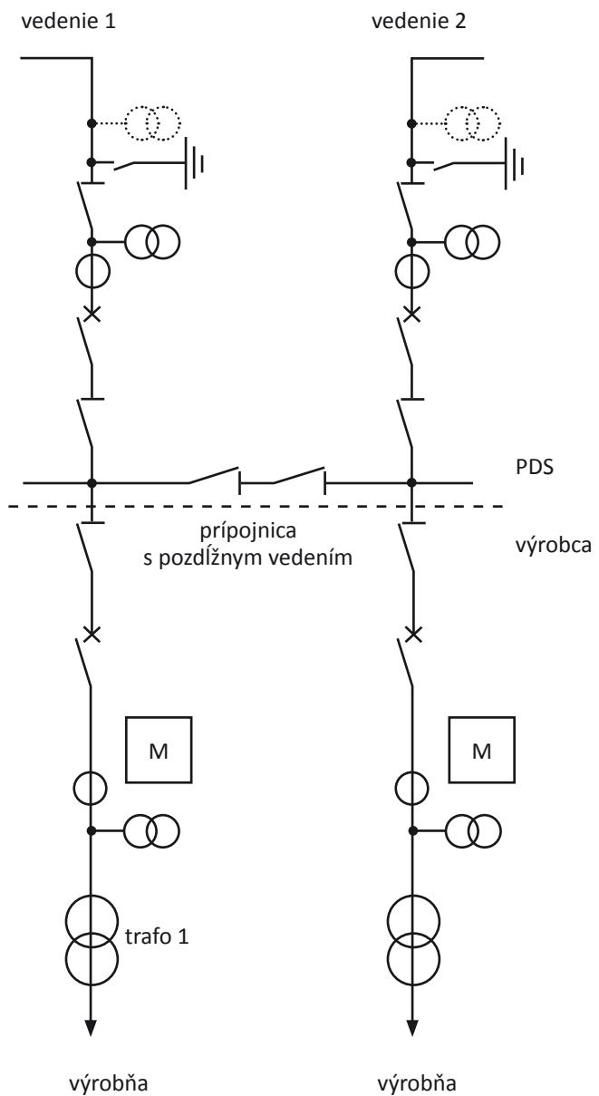
**Obr. 13:** Pripojenie výrobne zaslučkováním
