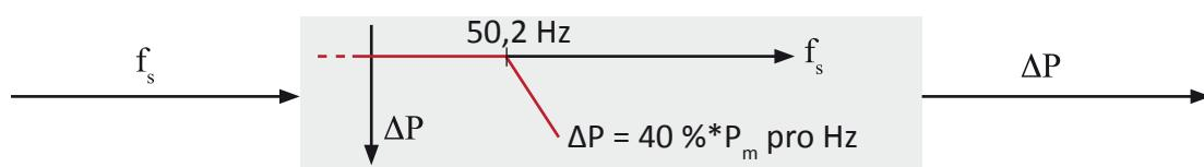
Obrázok 1 - Zniženie činného výkonu v závislosti od frekvencie siete
