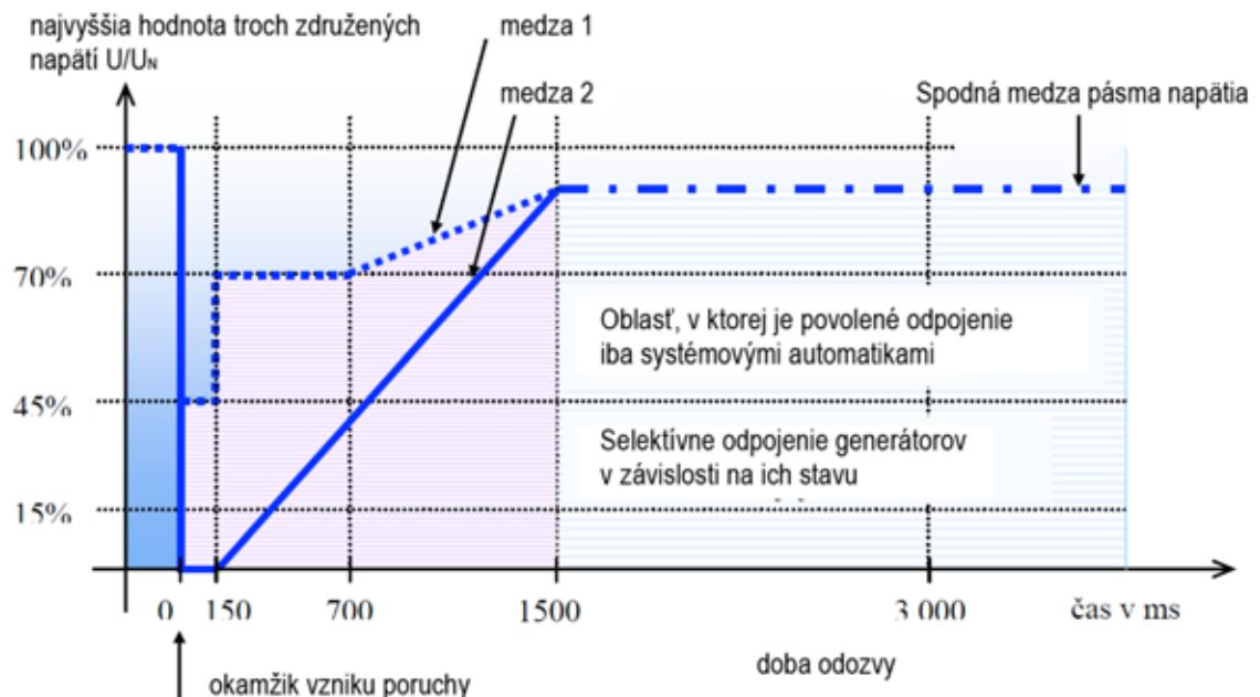
Obrázok 3: Medze poklesu napäťia v prípojnom bode pre výrobne s obnoviteľnými zdrojmi pri poruche v sieti
