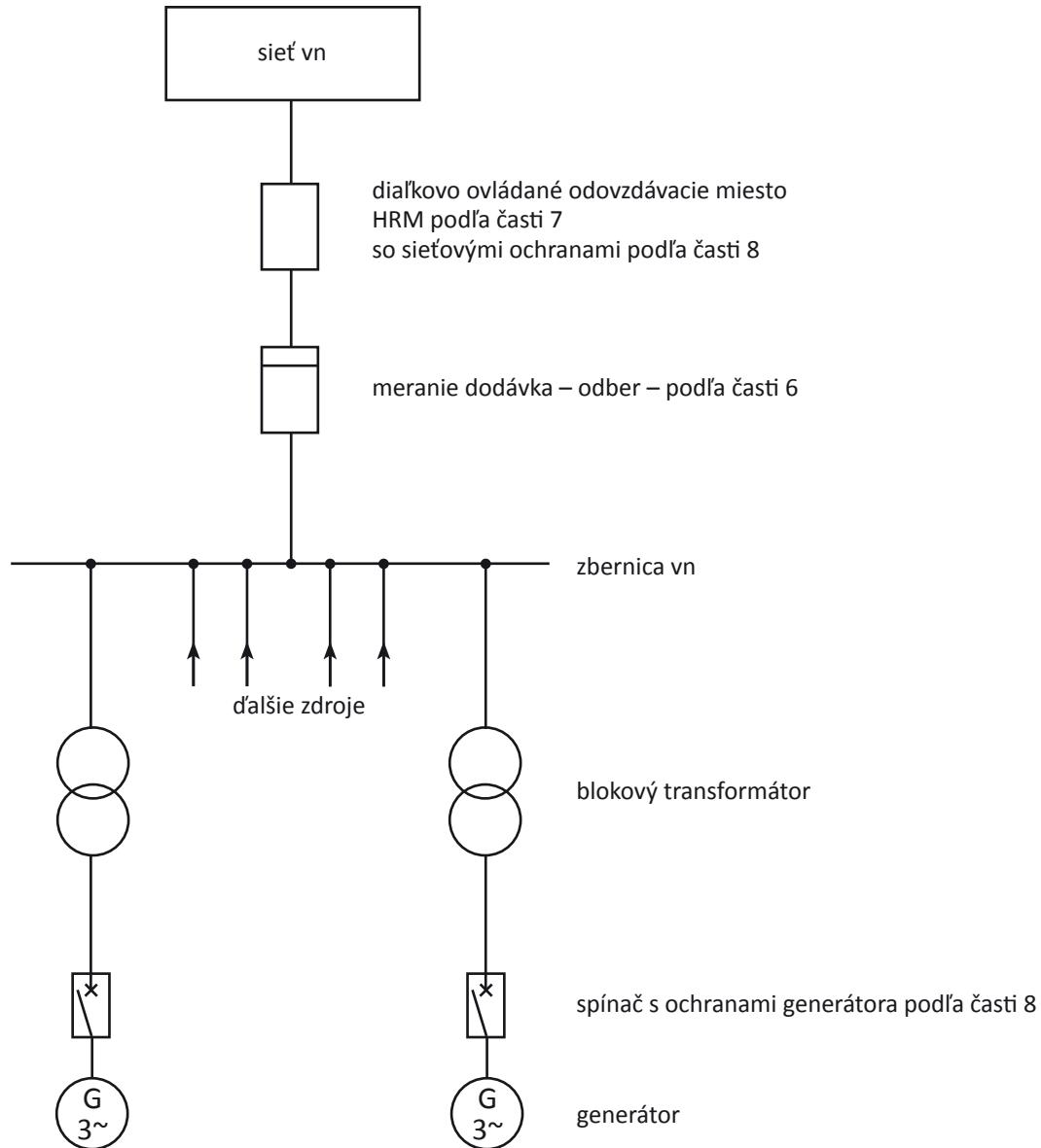
Obrázok 12: Niekoľko vlastných výrobní v paralelnej prevádzke so zbernicou vn
