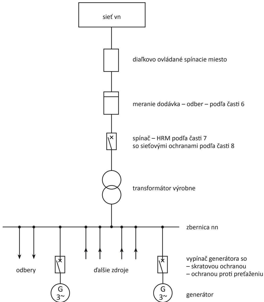
**Obrázok 11:** Niekoľko vlastných výrobní v paralelnom režime prevádzky so sieťou s možnosťou ostrovnej prevádzky
