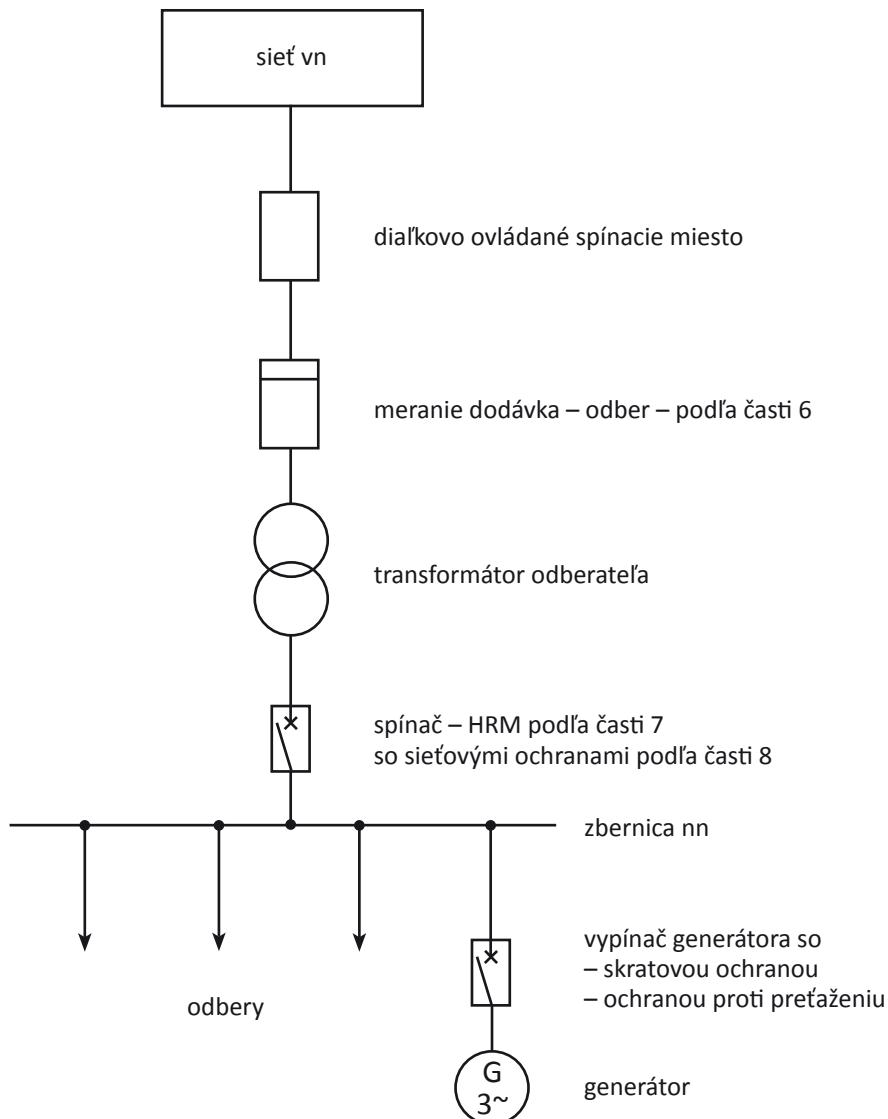
Obrázok 10: Vlastná výrobňa v paralelnej prevádzke so sietou s možnosťou ostrovnej prevádzky
