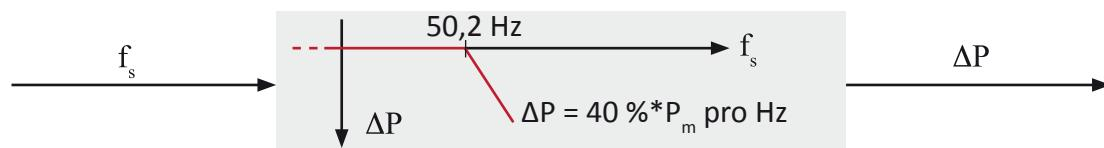
Obrázok 2 - Zníženie činného výkonu zdrojov pri nadfrekvencii
