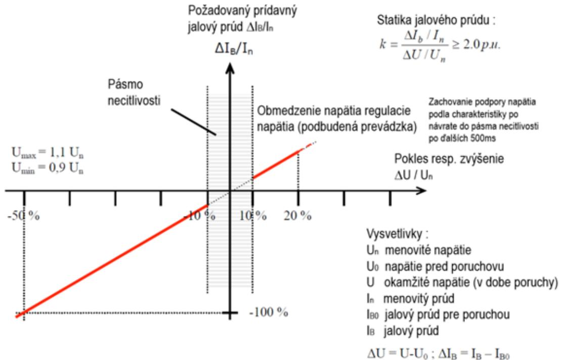
Obrázok 4: Princíp podpory napäťia pri poruchách v sieti výrobňami s obnoviteľnými zdrojmi
