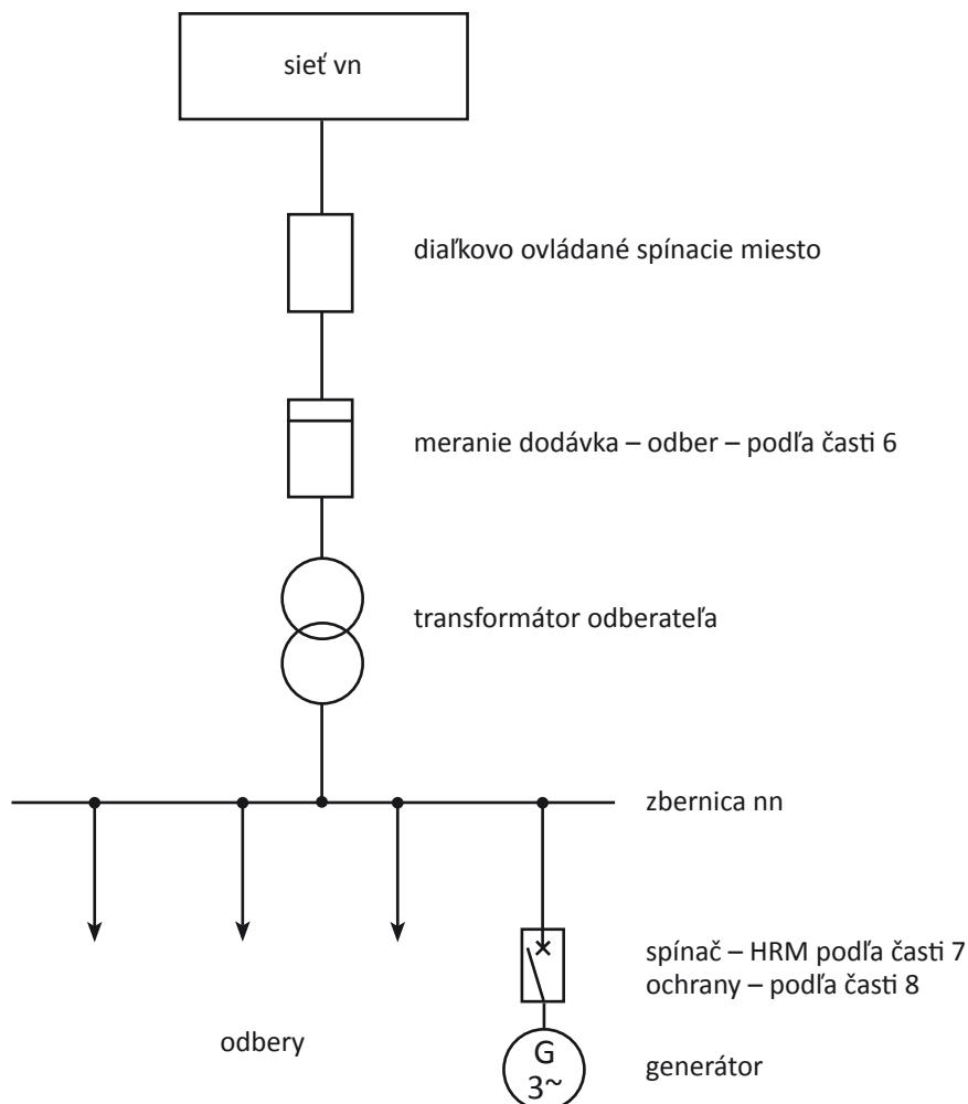
**Obrázok 9:** Jedna vlastná výrobňa v paralelnej prevádzke so sieťou bez možnosti ostrovnej prevádzky
